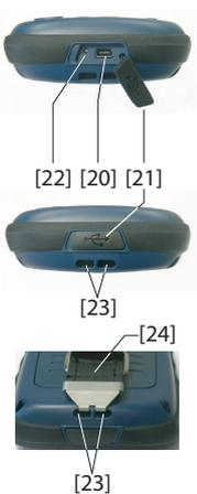
An der Unterseite befindet sich ein Mini-USB-Anschluss **[20]**. Er liegt hinter einer Gummischutzklappe **[21]**, die mit einem Fingernagel oder einem spitzen Gegenstand von links nach rechts geöffnet werden kann.
